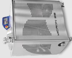
Refinador por esferas para o refinamento do produto
